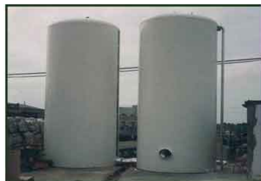
Cilíndrico vertical de poliéster con fibra de vidrio
