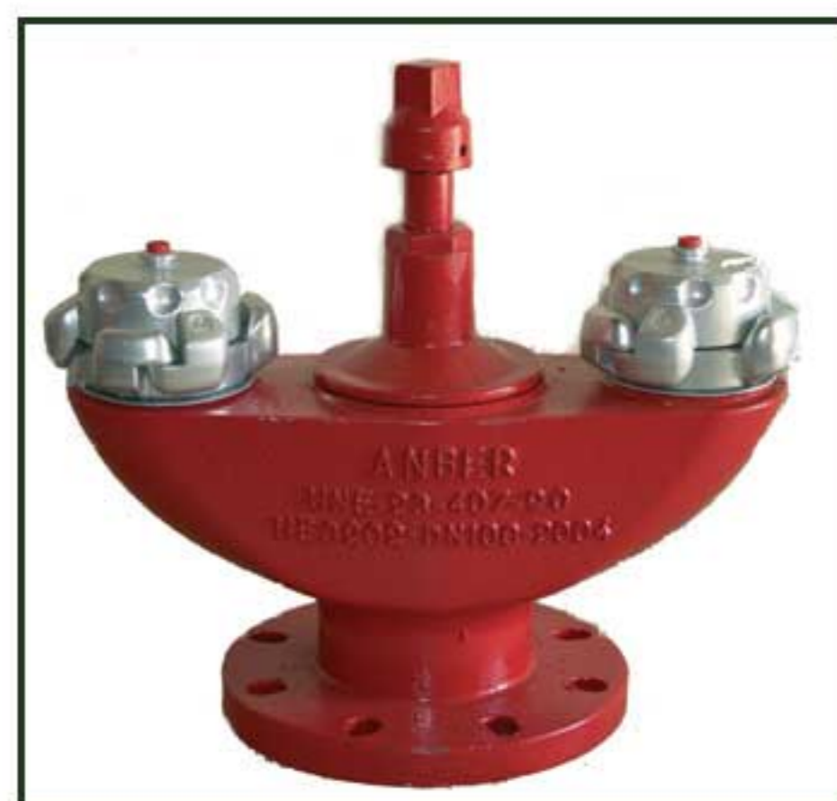
Hidrante de arqueta con tapa en hierro fundido, toma de entrada 4" y dos salidas de 70mm con racord Barcelona
